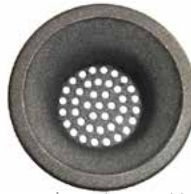
13 pav. Švarus degimo indelis. Jokių apnašų viduje, visos skylės švarios ir matomos.
